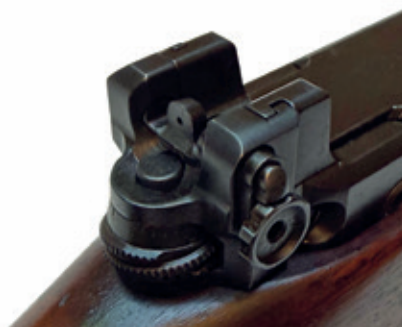
La hausse, dérivable et zérotable, n'a rien à envier à celle d'une carabine de compétition.
