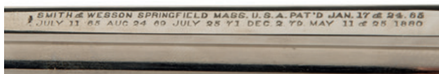
Marquages de brevets sur le renfort du canon d'un modèle Double Action.
