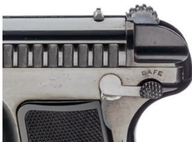
La sûreté manuelle, à grand débattement, est placée sur la gauche de l'arme au niveau du busc de la poignée.
