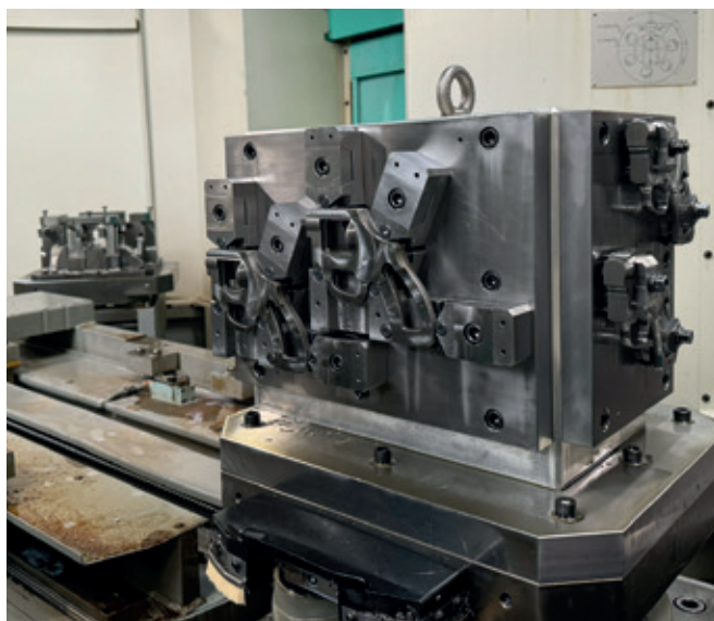
Usinage des ébauches de carcasses.
