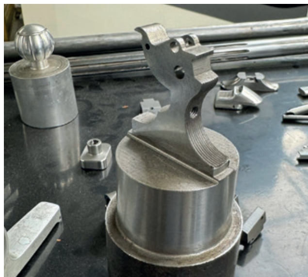
Les pièces sont usinées dans la masse.
