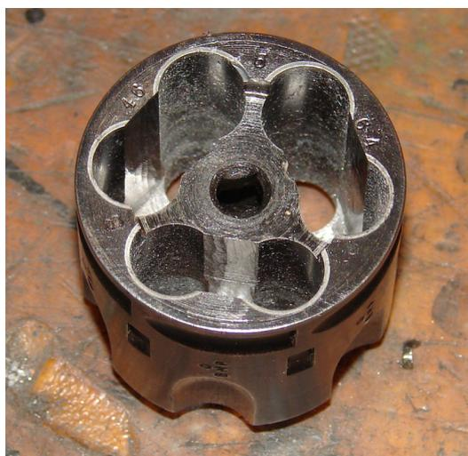
Fig. 136. Fraisage des chambres d'un barillet.
