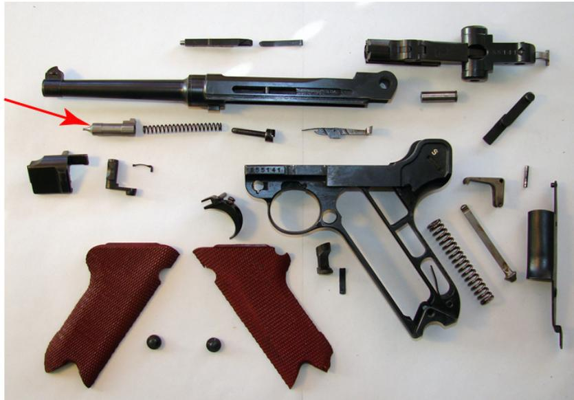
Fig. 178. Percuteur (flèche rouge) d'un Parabellum 06-29.
