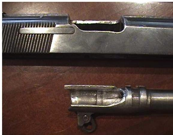
Fig. 165. Exemple de neutralisation espagnole d'un pistolet.
