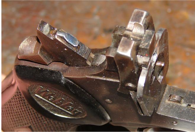
Fig. 133. Diminution du percuteur d'un revolver.
