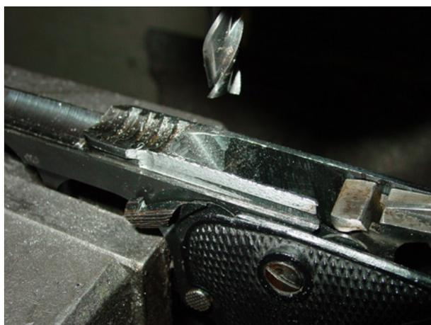
Fig. 137. Suppression de la rampe d'alimentation sur un pistolet.
