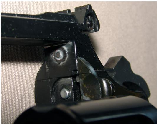
Fig. 145. Percuteur raccourci et trou de passage soudé sur un revolver Mauser Modèle L22.
