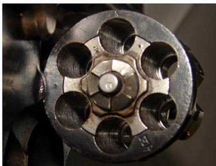
Fig. 149. Fraisage des chambres d'un barillet de revolver Modèle 1892. Michel Braekman ©HEAA Arc.
