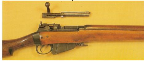
Fig. 56. Magasin Lee vertical et culasse tournante à verrouillage arrière sortie. Cormack. p.107.
