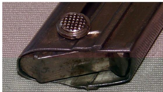
Fig. 150. Meulage d'une des lèvres d'un chargeur de Luger P08. Michel Braekman ©HEAA Arc.
