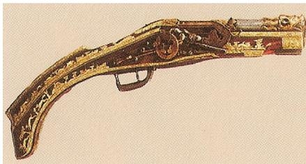
Fig. 24. Pistole à rouet. Longueur : 450 mm, longueur du canon : 170 mm, calibre : 12.4 mm. Kunz. p.34.
