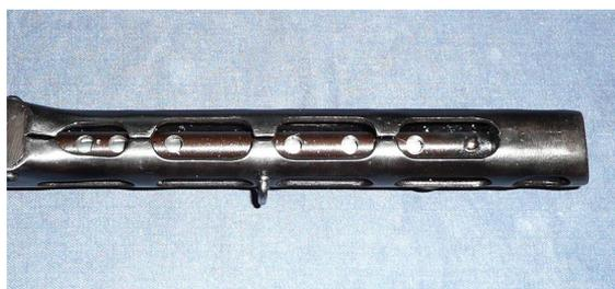
Fig. 129. Trous dans le canon d'un PPSH 41.
