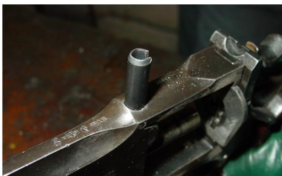
Fig. 134. Insertion d'une goupille élastique dans la carcasse d'un revolver.
