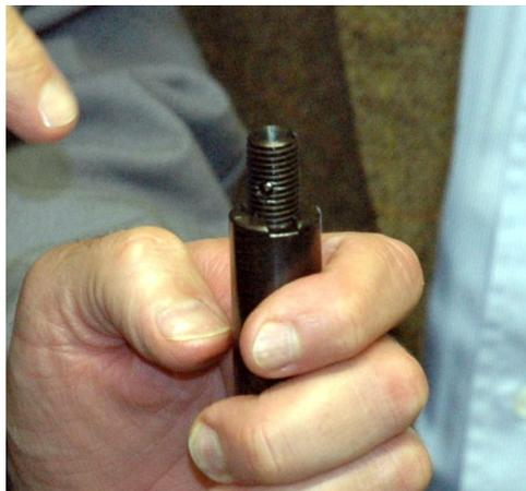
Fig. 142. Introduction du bouchon fileté.
