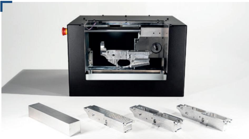
Le concepteur indique et se vante du fait qu'il faut à peine 3 heures pour passer d'un bloc d'aluminium brut à un lower d'AR-15. Selon lui, l'ère des armes à 80% est terminée et voici venu le temps des armes à 0%.
