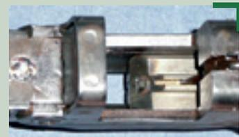
Par exemple, nous pouvons voir sur cette ancienne neutralisation de PPSH la tête de culasse fraisée à 45% et l'orifice du percuteur bouché avec de la soudure auto-trempante. Aujourd'hui, une telle expertise serait impossible, l'accès par le puits du chargeur étant rendu impossible par sa fixation.
