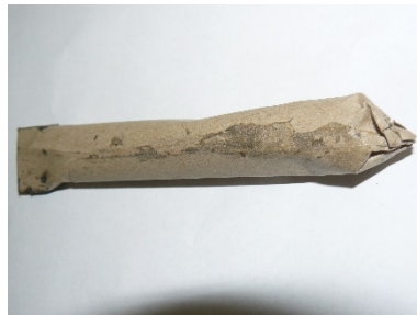
Cartouche en papier de fusil réglementaire Français (la balle ronde en plomb est dans la partie avant de la cartouche devant la poudre)
