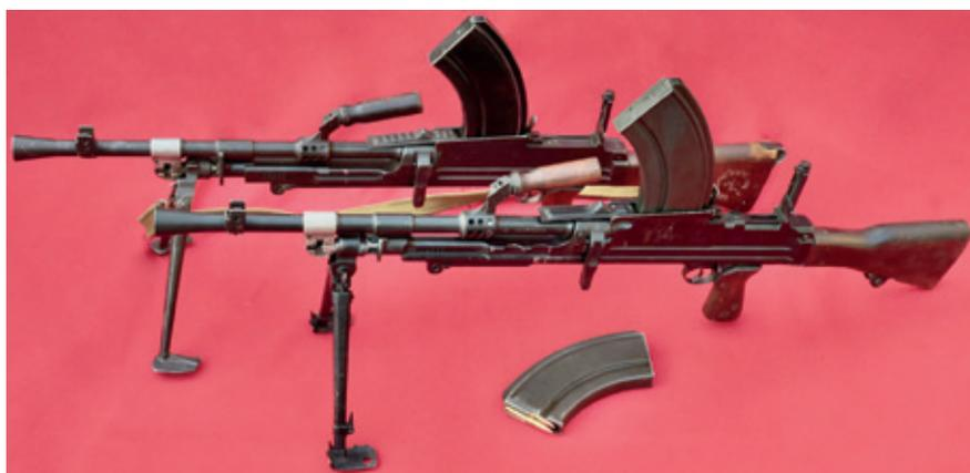
FM BREN Mk.II et Mk.III : le meilleur fusil mitrailleur de la 2e GM, de conception tchécoslovaque, construit sous licence au Royaume-Uni suivant le principe du Peddled Scheme, mobilisant une myriade de petits ateliers. Bridé au coup par coup et chargeurs limités à 10 coups.
