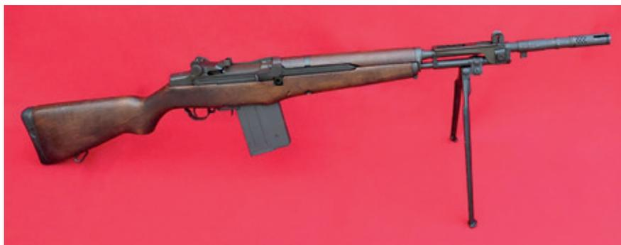
Fusil BM59 : l'évolution ultime du fusil de Jean C. Garand de 1936, réalisée après-guerre par les ingénieurs de Beretta. L'emprunt de gaz est occulté et le piston raccourci pour garantir l'irréversibilité de la transformation ; chargeurs limités à 10 coups.
