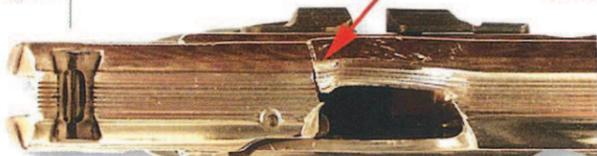
Le tir d'une cartouche 9 mm Browning court à balle dans un pistolet d'alarme Kimar 75 Auto a entraîné l'éclatement de la glissière (© J. Huon).
