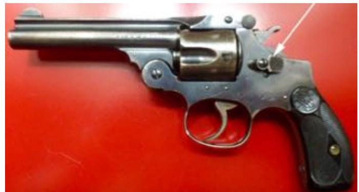
Smith & Wesson calibre .38 « Perfected Model ». Le pontet n'est plus rapporté mais usiné dans la masse de la carcasse, de même que le guidon est usiné dans la masse du guidon. La seule innovation technique sur ce modèle est le poussoir (flèche qui renforce le verrouillage du barillet. C'est là la seule disposition qui peut faire discuter le classement en catégorie D2 de cette variante. (Photo BP)
