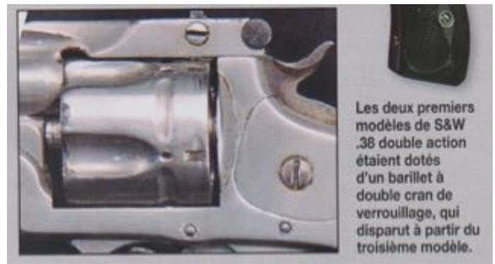
Vue du double cran de verrouillage du barillet, présent sur les calibres .38 à double action des premiers et deuxième modèles.
