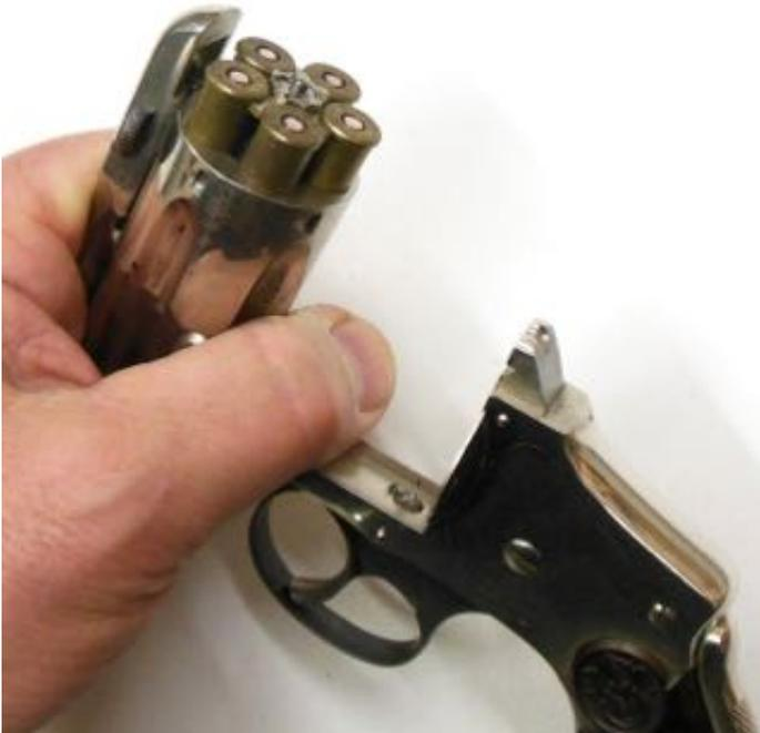
*Les Smith&Wesson « Top Break » se caractérisent par une extraction automatique des cartouches contenues dans le barillet ou des étuis tirés, après basculement vers l'avant de l'ensemble canon-barillet.*
