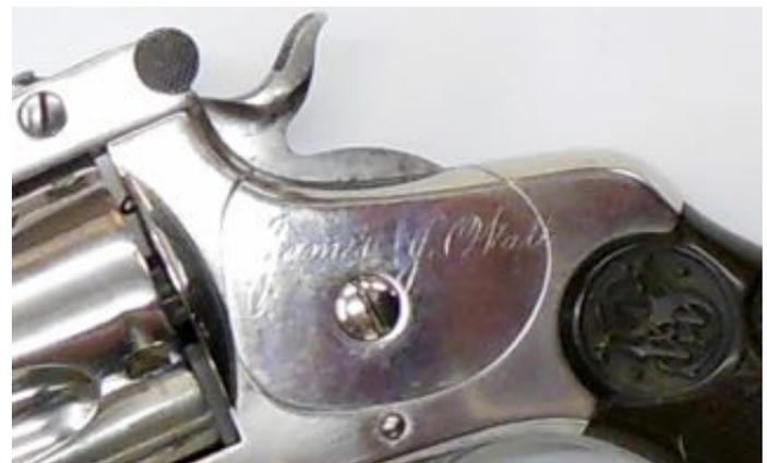
*Le second modèle en calibre .38 et les suivants, comportent une plaque de recouvrement à base ovale, qui impose une découpe de taille moins importante que celle des premiers modèle et fragilise moins la carcasse de l'arme.*
