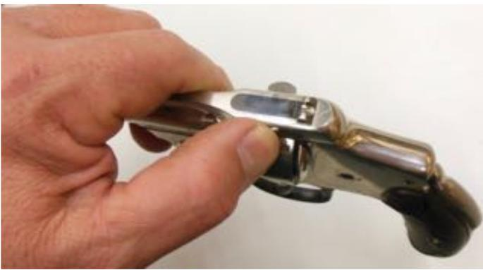
Verrouillage de canon par poussoir transversal du .38 Safety 1er modèle.
