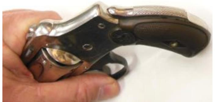
*Les S&W à double action « Top Break » de la version « Safety Model » (aussi appelée « New Departure ») comportent un chien interne (ce sont donc des revolvers « Hammerless ») et une pédale de sûreté à l'arrière de la poignée, qui ne permet le tir que si la poignée est solidement serrée.*
