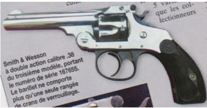
Le barillet de ce revolver calibre .38 du troisième modèle ne comporte plus qu'une série de crans de verrouillage du barillet, comme ce sera le cas pour tous les revolvers des modèles suivants.
