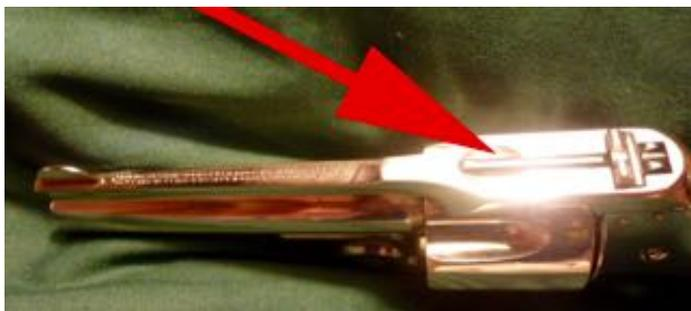
Poussoir d'ouverture placé au sommet de la bande du canon d'un « Safety Model » calibre .38 du troisième modèle. (Photo : BP)
