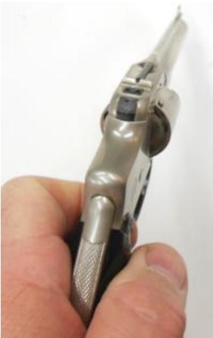
Détail du verrouillage par poussoir axial du .38 « Safety Model » quatrième modèle.
