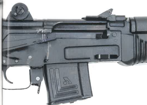
SAR-M14SF. Sur cette arme civile, le sélecteur sur le boîtier de culasse n'a que deux positions.
