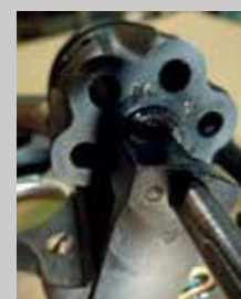
Ce revolver converti par Manufrance en cal 6 mm annulaire a été parkérisé.
