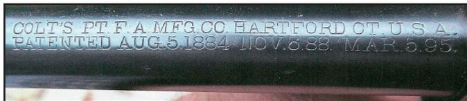
Ce Colt 89 en cal 41 LC comporte des dates de brevets échelonnées de 1884 à 1895 et il a été fabriqué en 1904.
