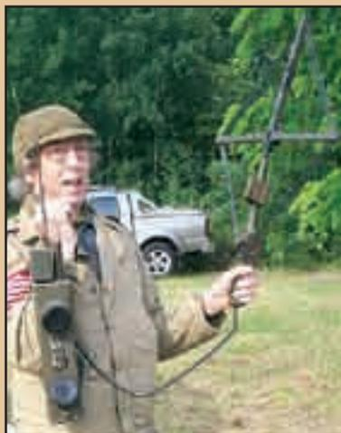
**Le SCR 536. Sa mise au point et sa production sont identiques au SCR 511. En 1945 plus de 130 000 exemplaires seront fabriqués. Ce Handy-Talkie conçu pour être tenu à la main, est composé des éléments suivants :**
