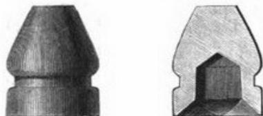
Fig. 362 et 363. — Balle modèle 1863 et coupe verticale de cette balle.
