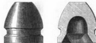
Fig. 360 et 361. — Balle modèle 1857 et coupe verticale de cette balle.
