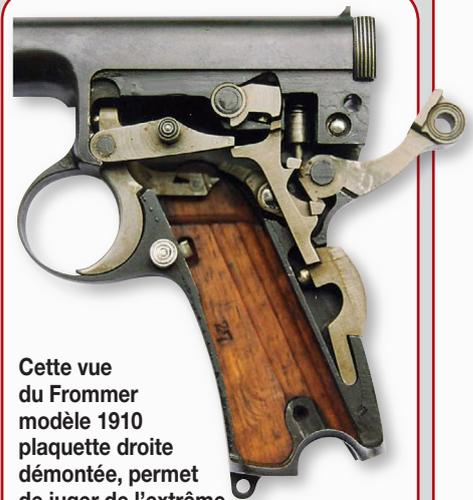
Cette vue du Frommer modèle 1910 plaquette droite démontée, permet de juger de l'extrême complexité du mécanisme, qui doit le faire considérer comme une arme de collection sans aucune valeur opérationnelle.
