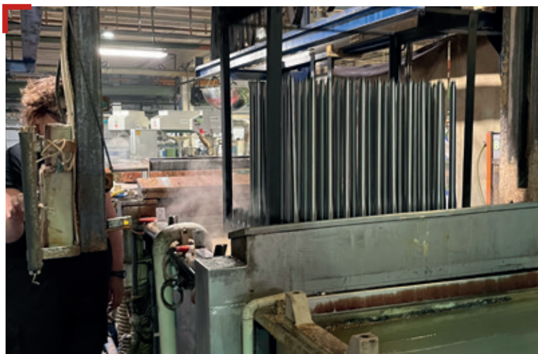
Entrée des canons dans les bains de traitement de surface.
