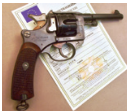
Les barilletts des revolvers ne tournent plus, les chiens sont bloqués et rien n'est démontable de la plaque de recouvrement aux plaquettes.
